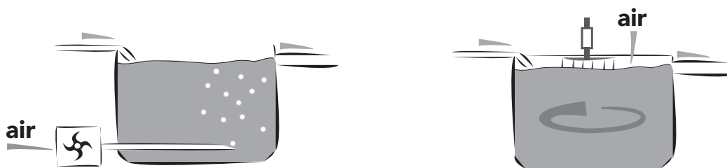
Insufflation d'air par ventilateur ou compresseur
